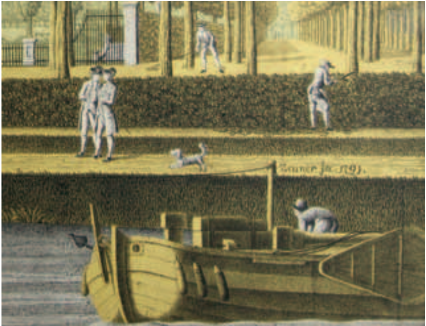
Afb. 5. Detail uit afb. 1. Signatuur en datering. Het vrachtschip heeft de mast gestreken met behulp van het contragewicht dat voor het jaagmastje boven dek steekt.
