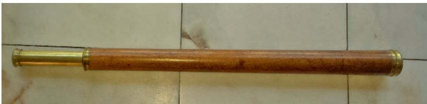
Afb. 5 Voorbeeld van een ‘Lunette Chappe’, een verrekijker die gebruikt werd om de seinen te lezen. Deze kijker is tijdens de televisieopnames gebruikt. Het was een bruikleen van de collectie Zuylenburgh te Oud Zuilen. Het betreft kijker nr. 14, die destijds in Vlissingen is gebruikt.
